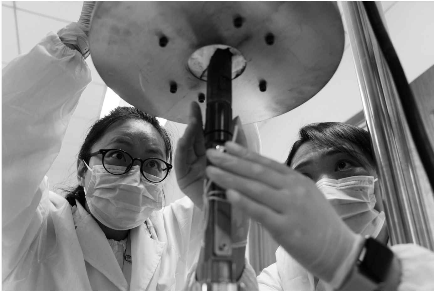
在位于中国科学院上海应用物理研究所嘉定园区的材料蠕变实验室，科研人员在放置用于建设液态燃料钍基熔盐实验堆的合金材料蠕变试验样品(2025年10月23日摄)。
