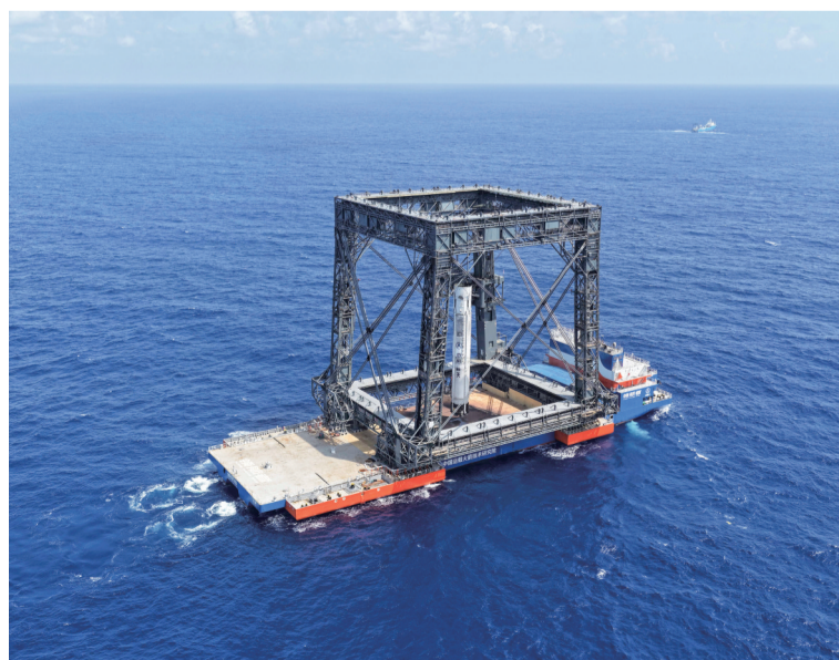
这是海上回收平台通过网系捕获方式成功回收长征十号乙运载火箭一子级(7月10日报,无人机照片)。
